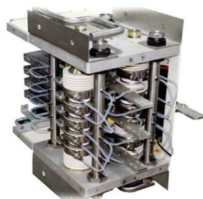
1 3L-NPC IGCT功率组件 3L-NPC IGCT power assembly
